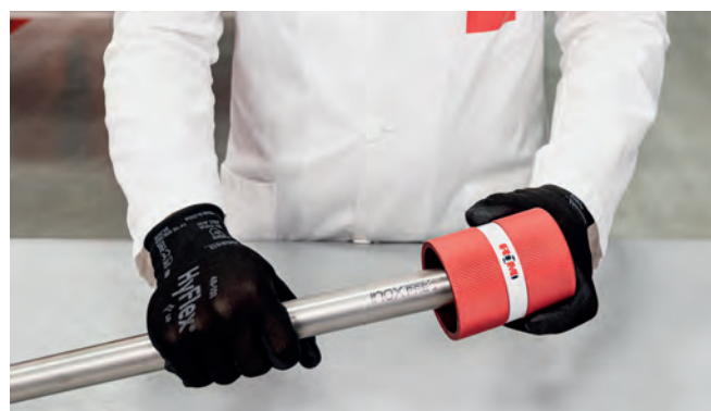
Ilustracja 27 – Stępanie krawędzi rury
